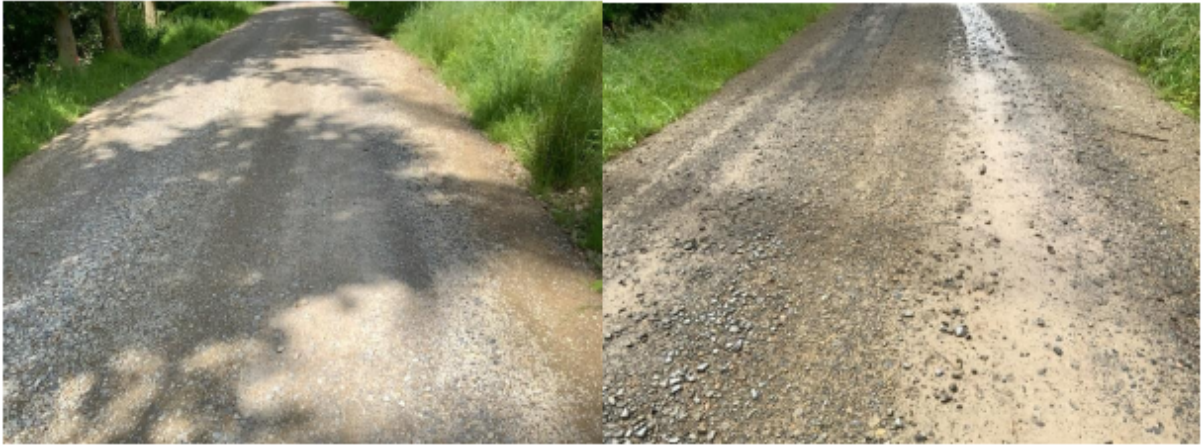
Abbildung 6: Aufnahmen des im Zementbaumischverfahren mit Zusatzadditiv gebauten Teilabschnitts vor (links) und nach (rechts) des Belastungszeitraums
