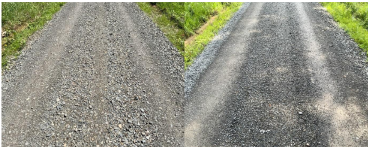
Abbildung 5: Aufnahmen des sand-wasser-gebundenen Teilabschnitts vor (links) und nach (rechts) des Belastungszeitraums
